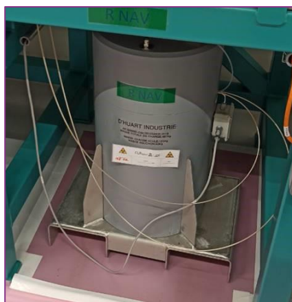
Figure 30 : Conteneur blindé pour flacons
