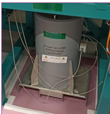
Figure 56 : Conteneur blindé pour flacons
